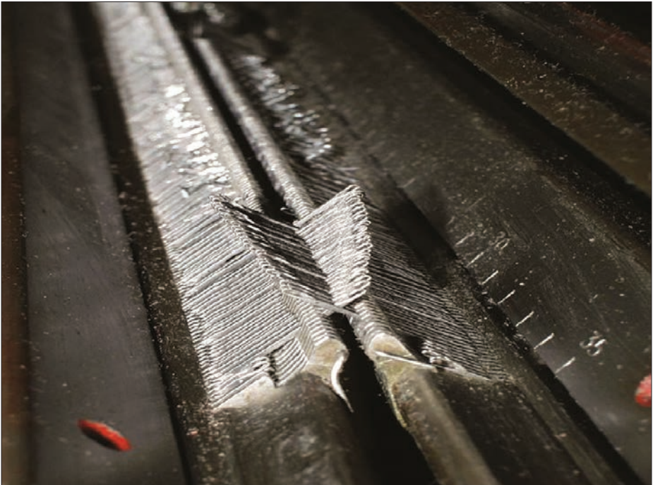
Figura 3. Confección de un tejido plano. La máquina que confecciona las prendas de tejido plano, se compone de dos hileras de agujas, colocadas en ángulo de 90^\circ de número variable.
